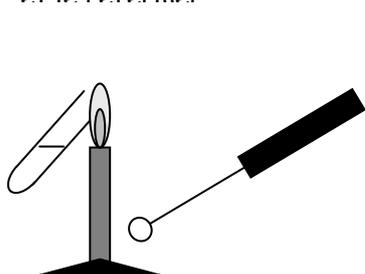
Flamber l'ouverture du tube à hémolyse contenant l'eau
