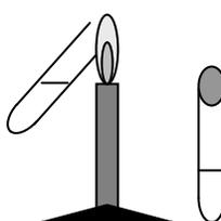
Flamber l'ouverture du tube à hémolyse et le refermer
